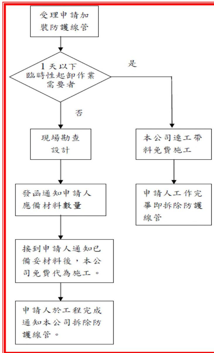
圖 4-1 配電線路防護措施作業申請流程
